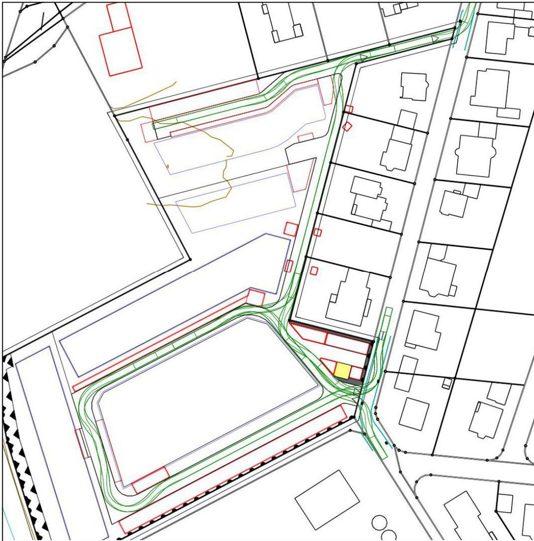
**Abbildung 5** Fahrkurven der Fahrzeugeckpunkte eines 3achsigen EU-Müllfahrzeugs mit Nachläufer im Plangebiet der Wohnbebauung „Am Stückertriesch“
