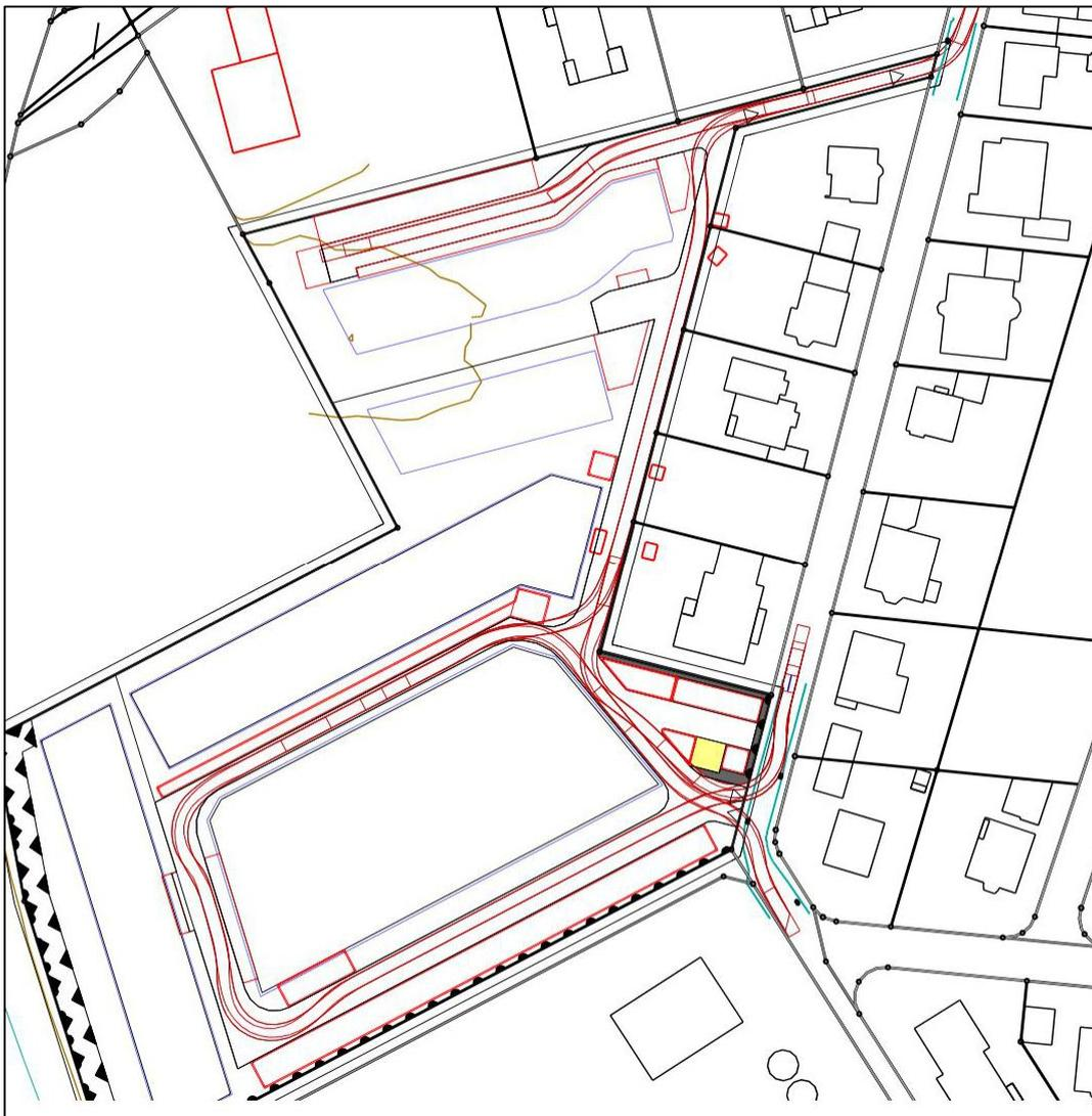
**Abbildung 4** Fahrkurven der Räder eines 3achsigen EU-Müllfahrzeugs mit Nachläufer im Plangebiet der Wohnbebauung „Am Stückertriesch“
